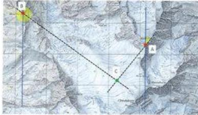
Individuiamo i punti di riferimento A e B, ben riconoscibili sulla carta e possibilmente distanti fra loro ma non opposti. Calcoliamo l'azimut di entrambi, ne determiniamo l'azimut inverso e li riportiamo sulla carta. Dove si intrecciano le due linee diagonali originate da A e B, individuiamo la nostra posizione C.
